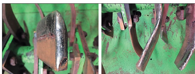
Рис. 4. Вид импортозамещающих ножей грядообразователя, наплавленных сплавом ПР-ФБЗХ, после наработки 60 га на машину (0,4 га на один нож)
