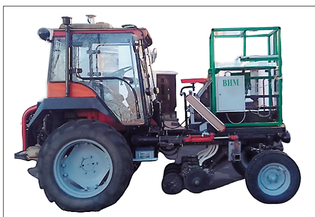
Рис. 5. Схема и экспериментальный образец сеялки селекционной самоходной роботизированной для второго этапа работ (СССР-2): 1 – роботизированное кассетное загрузочное устройство карусельного типа; 2 – самоходное шасси типа Т-16; 3 – высевальный аппарат автономного высева; 4 – двухдисковый сошник; 5 – семяпроводы; 6 – блок управления
