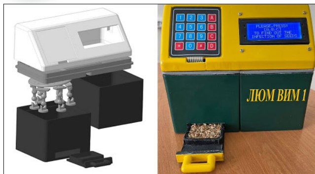
Рис. 2. 3D-модель корпуса (слева) и внешний вид прототипа оптического устройства экспресс-диагностики заражения семян фузариозом (справа)
