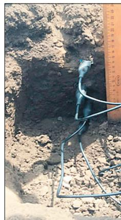
Рис. 4. Датчики влажности почвы, установленные по слоям
