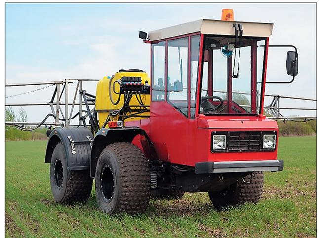
Рис. 1. МЭС-600 с шинами сверхнизкого давления 1020x420-18 модели Бел-79 при испытаниях
