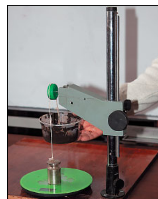
Рис. 2. Лабораторная установка для определения силы адгезии (разработка ВИМ)
