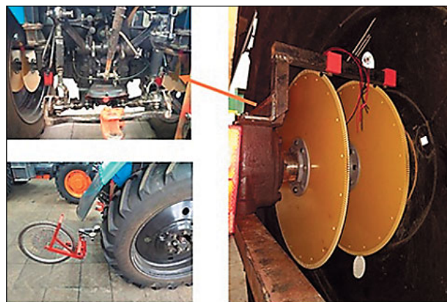
Рис. 3. Вид экспериментальной установки на тракторе МТЗ-82.1. Расположение оптических датчиков с метками на мосту (левый верхний) на валу, детальный вид (правый), дополнительное колесо с датчиком для измерения реальной скорости трактора (левый нижний)
