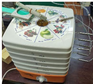
Рис. 3. Конвективная сушильная установка «РОТОР СШ-002» с датчиками температуры и влажности
