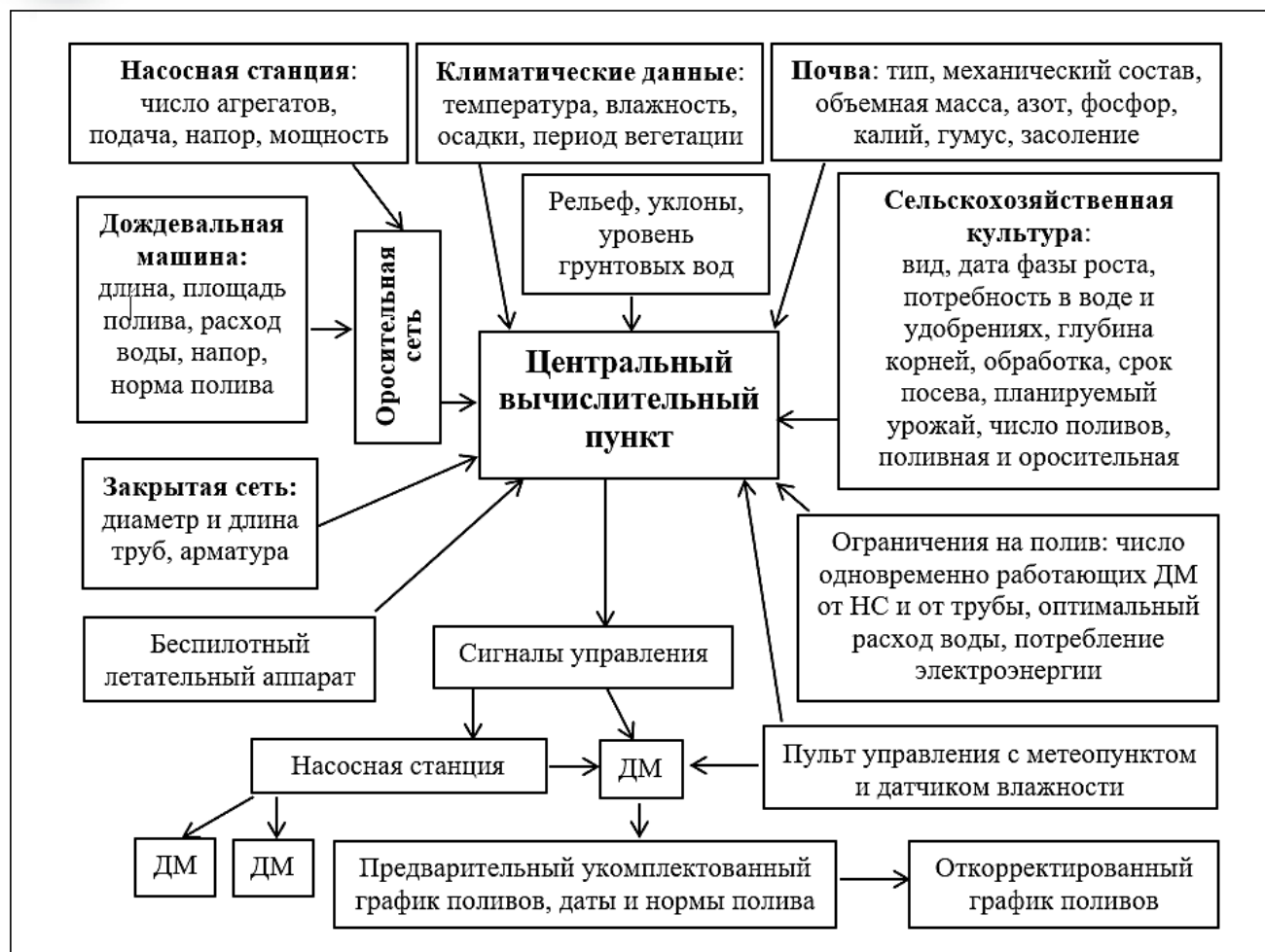
Рис. 2. Схема роботизированного оросительного комплекса для выращивания сельскохозяйственных культур на орошаемом участке
