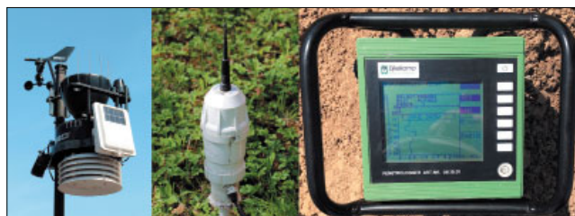
Рис. 2. Оборудование для агромониторинга (слева направо): метеостанция Davis Vantage Pro 2; Sentek COMPACT Drill & Drop TriSCAN; пенетрологгер Eijkelkamp Fig. 2. Agromonitoring equipment (from left to right): Davis Vantage Pro 2 weather station; Sentek COMPACT Drill & Drop TriSCAN; Eijkelkamp penetrometer
