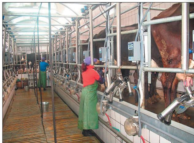
Рис. 5. Модульные доильные установки «елочка» УДЕ-М для беспривязного содержания (2005 г.)
