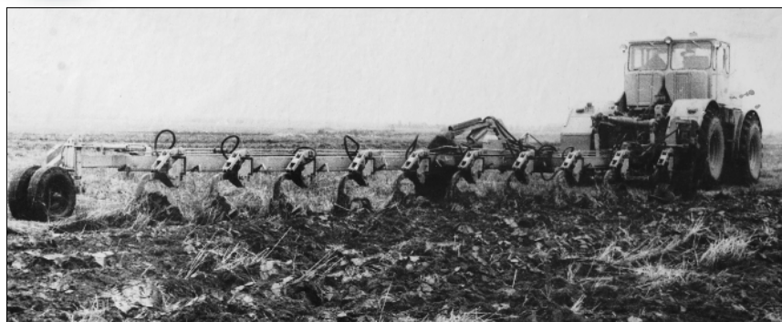
Рис. 3. Испытания плуга с регулируемой шириной захвата и предохранителями от камней
