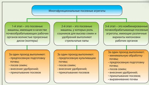
Рис. 1. Классификация многофункциональных посевных агрегатов
