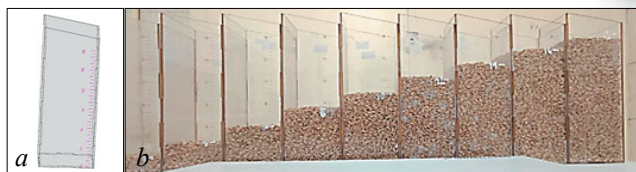
Рис. 2. 3D-модель пробоборника (а) и набор пробоборников со слоем зерна от 2 до 18 см (б)
