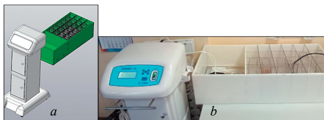
Рис. 1. Лабораторная установка с блоком управления источниками излучения и панелью излучателей низкочастотных электромагнитных волн: а – 3D-модель установки; б – магнитотерапевтический прибор
