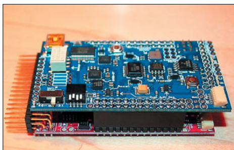
Рис. 18. Полетный контроллер ArduPilot Mega v1.0 Fig. 18. ArduPilot Mega v1.0 flight controller
