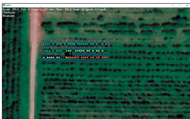
Рис. 9. Интерфейс программного модуля для построения маршрута движения роботизированной платформы
