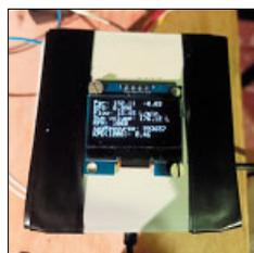
Рис. 4. Прототип устройства во время стендовых испытаний изношенного шестеренного насоса
