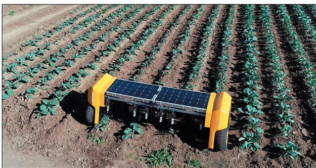
Рис. 1. Автономный полевой робот для дифференцированного внесения агрохимических средств в полевых условиях
