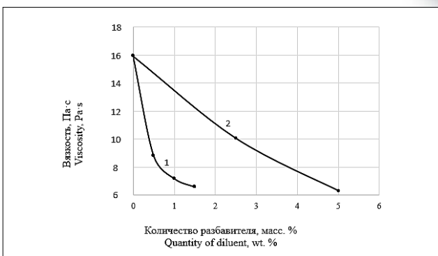
Рис. 6. Зависимость вязкости эпоксидной смолы ЭД-20 от введения различных разбавителей: 1 – ацетон; 2 – ДЭГ-1
