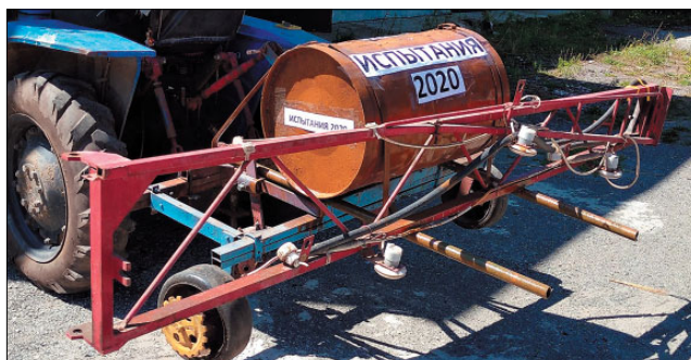
Рис. 2. Лабораторный образец агрегата для горной зоны на базе мини-трактора Feng Shou 180
