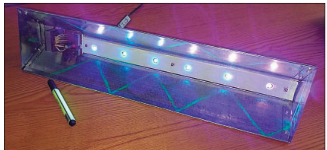
Рис. 4. Эритемный УФ-облучатель на основе светодиодов Fig 4. Erythema UV irradiator based on LEDs
