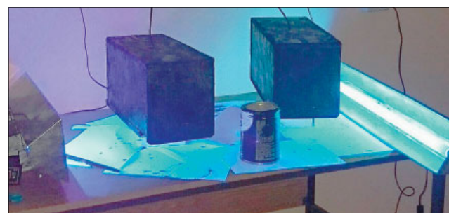
Рис. 6. Эксперимент по ускорению полимеризации эмали Fig.6. Experiment aimed to accelerate enamel polymerization
