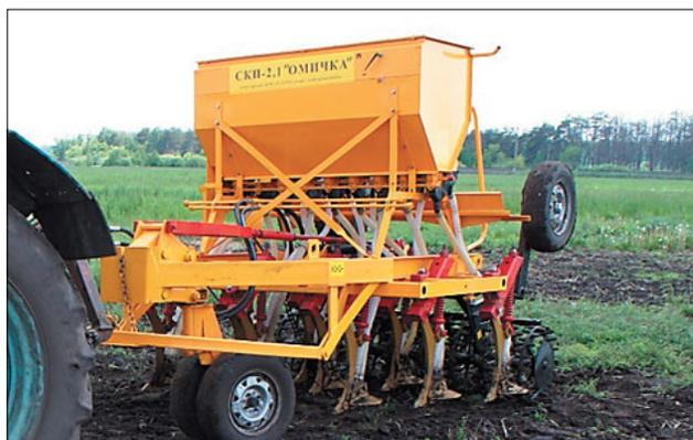
Рис. 3. Сеялка СКП-2,1М с экспериментальными сошниками
