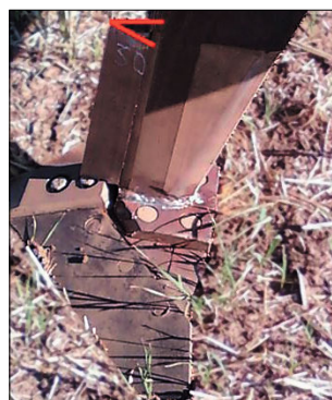
Рис. 1. Угол заточки стойки рабочих органов
