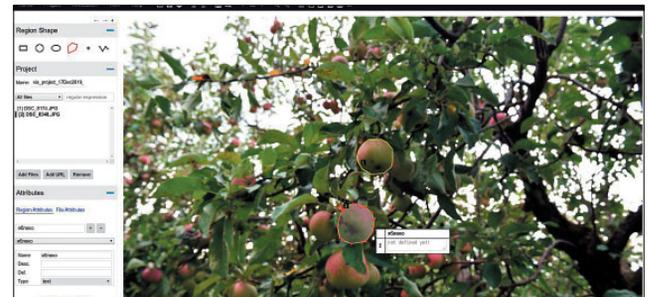
Рис. 4. Процесс разметки данных и выделения классов изображения в VGG Image Annotator
