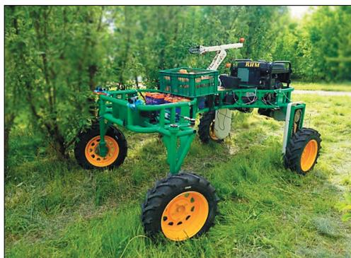
Рис. 7. Полевое тестирование роботизированного манипулятора на УРП
