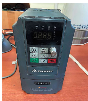
Рис. 3. Частотный преобразователь мощностью 7,5 кВт Fig. 3. Frequency converter with the capacity of 7.5 kW
