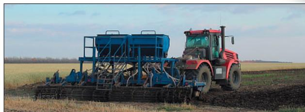
Рис. 3. Агрегат, состоящий из трактора «Кировец» К-744Р2 и культиватора-удобрителя, оборудованного системой ДВУ
