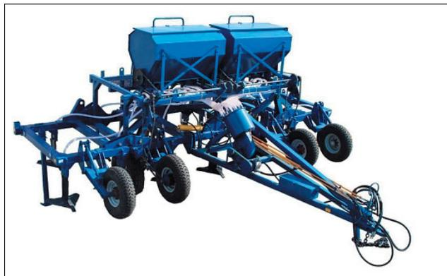
Рис. 1. Культиватор-удобритель для внутривспашечного внесения минеральных удобрений (общий вид)
