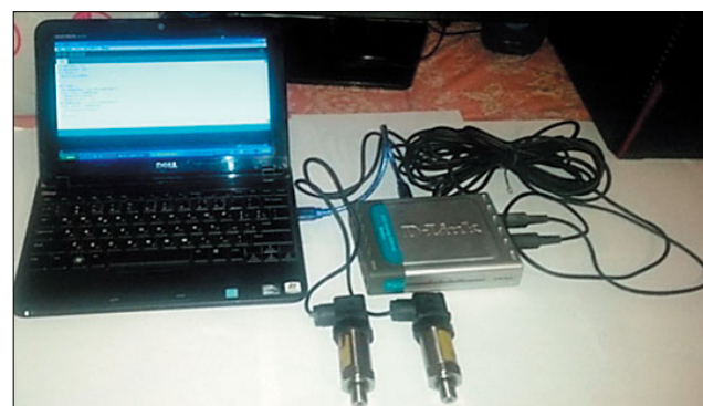
Рис. 3. Аппаратура для измерения давления в гидросистеме и времени перевода заднего моста с одного клиренса на другой
