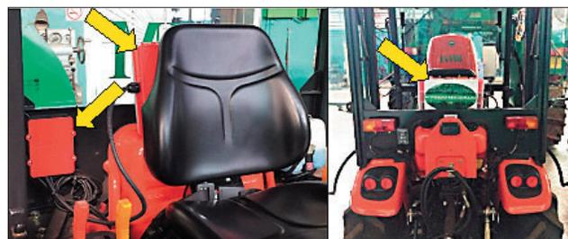
Рис. 6. Расположение бортового компьютера в тракторе Kioti CK22
