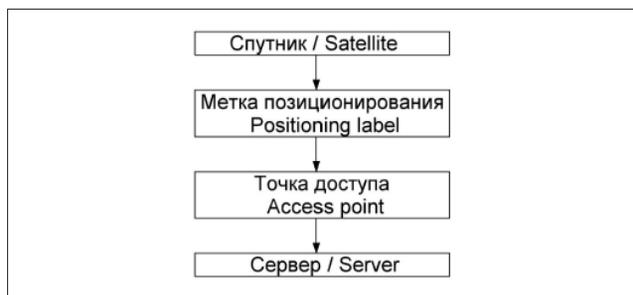
Рис. 1. Модель системы позиционирования *RealTrac*
