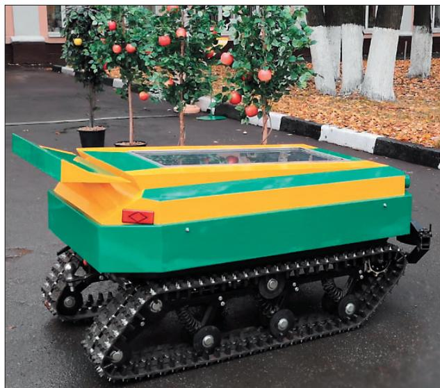
Рис. 10. Малогабаритное роботизированное транспортно-технологическое средство
