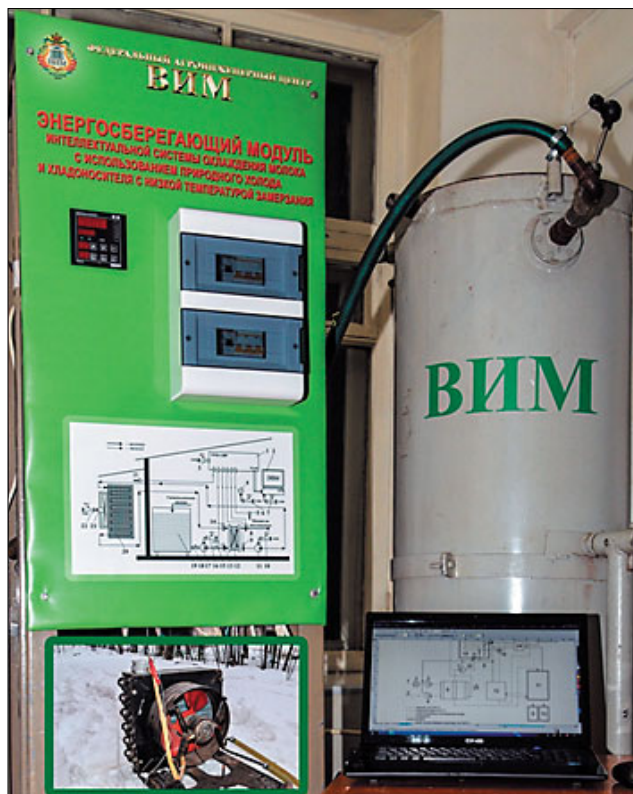
Рис. 3. Энергосберегающий модуль для охлаждения молока на фермах с использованием природного холода и экологически безопасных хладоносителей с низкой температурой заморзания Fig. 3. Energy-saving module for cooling milk on farms using natural cold and environmentally friendly coolants with low freezing point
