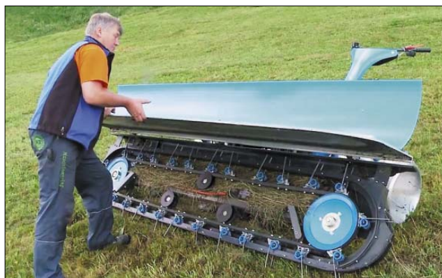
Рис. 1. Горизонтально-конвейерные грабли модели Hill Rake в агрегате с мотоблоком
