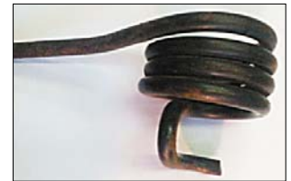
Рис. 3. Распределение нагрузки и характерная поломка за местом крепления болта
