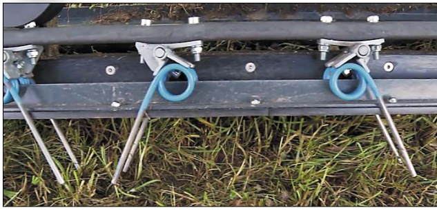
Рис. 2. Граблина с пружинным основанием на кронштейне на узком ремне (стрелкой показано устройство, предотвращающее сброс ремня)
