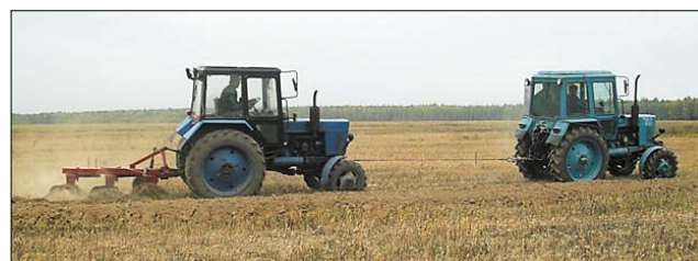
Рис. 3. Измерение тягового сопротивления плуга в полевых условиях
