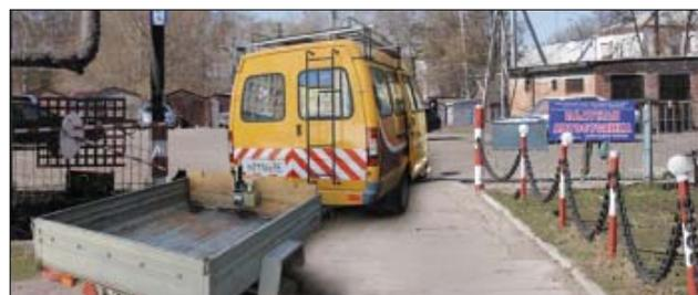
Рис. 7. Движение автопоезда задним ходом с порожним прицепом с гибкой связью в сцепном устройстве
