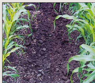
Рис. 5. Вид поверхности почвы после прохода спиральной лапы Fig. 5. Soil surface after spiral pass
