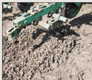
Рис. 4. Установка спиральной лапы на секции пропашного культиватора КРН-5,6 Fig. 4. Spiral mounting on the inter-row cultivator KRN-5.6 section
