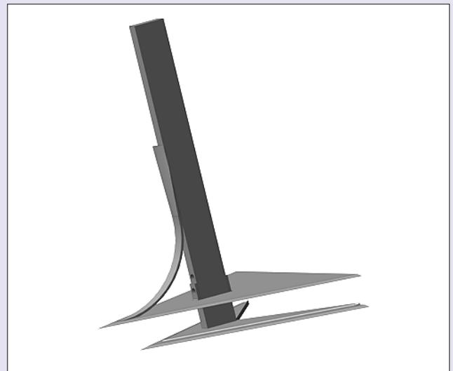
Рис. 2. 3D-модель двухъярусной почвообрабатывающей лапы
