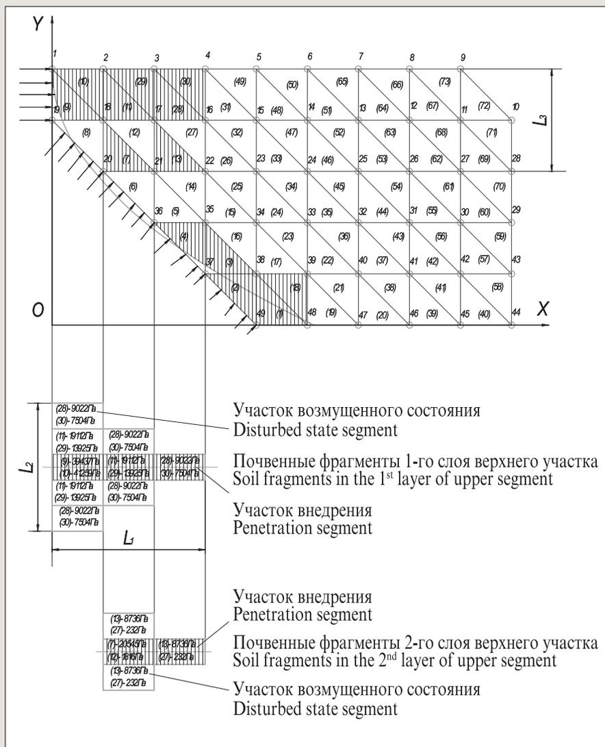
Рис. 3. Области возможного разрушения деформируемого слоя
