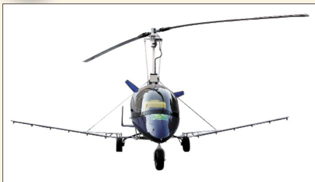
Рис. 1. Автожир для внесения жидких средств химизации
