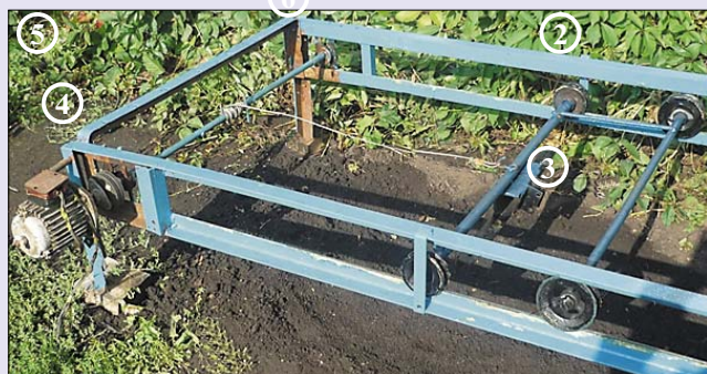
Рис. 1. Общий вид лабораторной установки: 1 – направляющая; 2 – тележка приводная; 3 – ролик металлический; 4 – электродвигатель; 5 – преобразователь частотный; 6 – связь канатная
