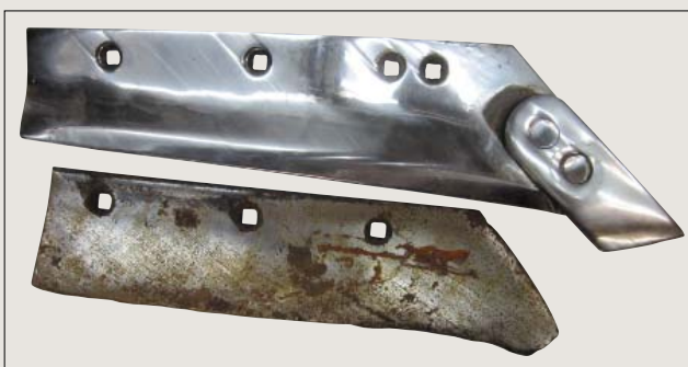
Рис. 3. Лемеха после испытаний: опытный лемех при наработке 15 га пригоден к дальнейшей эксплуатации (вверху); серийный лемех П702 при наработке 4,7 га достиг предельного износа (внизу)
